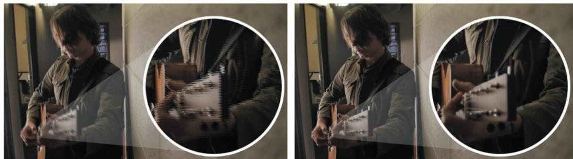
▲ Le balayage entrelacé (à gauche) peut présenter des contours crénelés, car l'image est divisée en deux demi-trames. Le balayage progressif (à droite) ne présente pas ce défaut.
